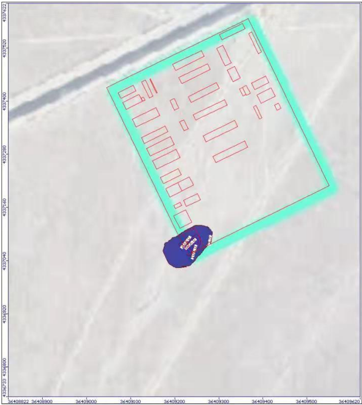
b、泄漏 60d 后停止泄漏，第 500d 地下水中耗氧量污染扩散平面图
