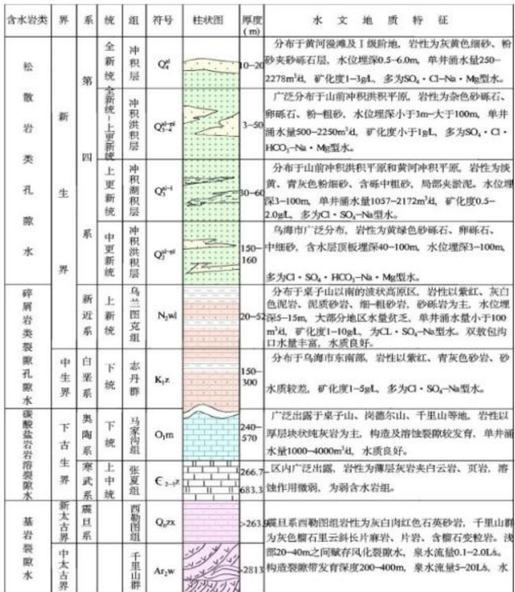
图 4.2.1-4 综合水文地质柱状剖面图
