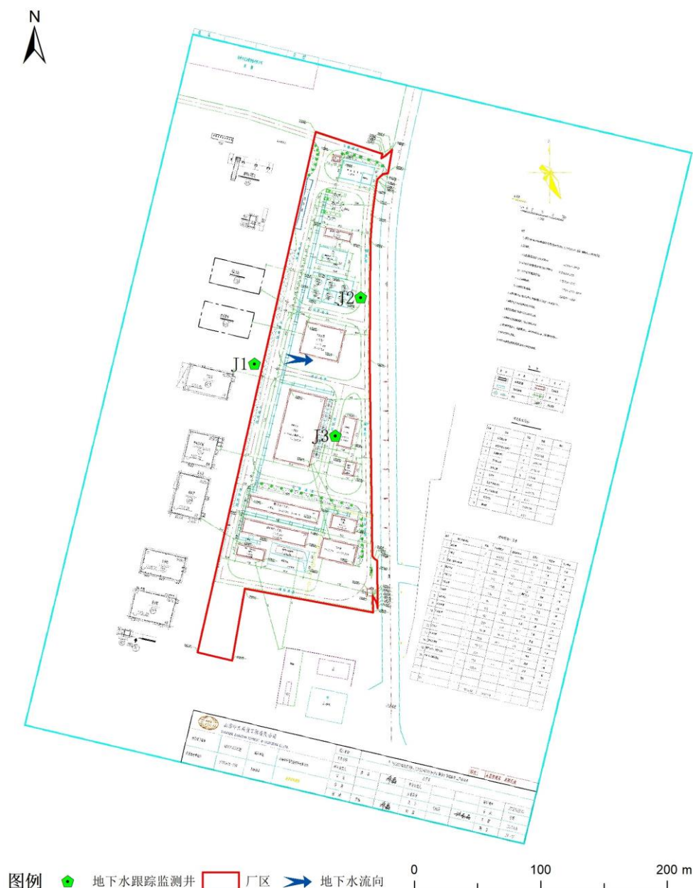
图 7.2.5-2 地下水跟踪监测布点示意图
