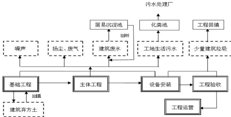
图 3.2-1 项目施工工艺流程及产污环节图
