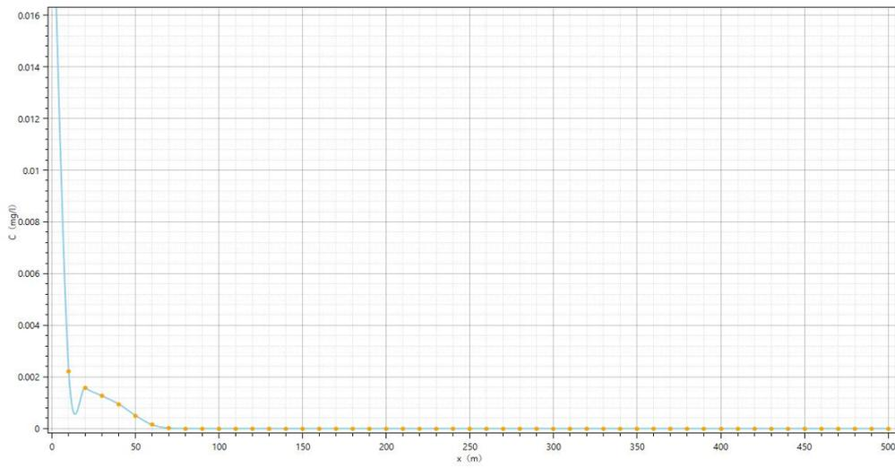
图 5.2-7 污染晕迁移 100 天氨氮扩散图
