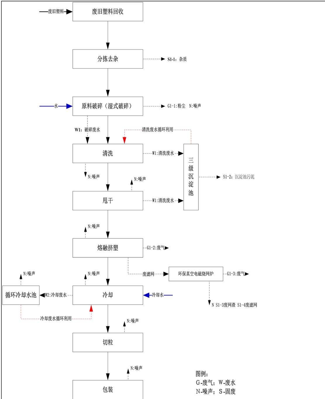
图 3.2-2 造粒工艺流程及产污环节图
