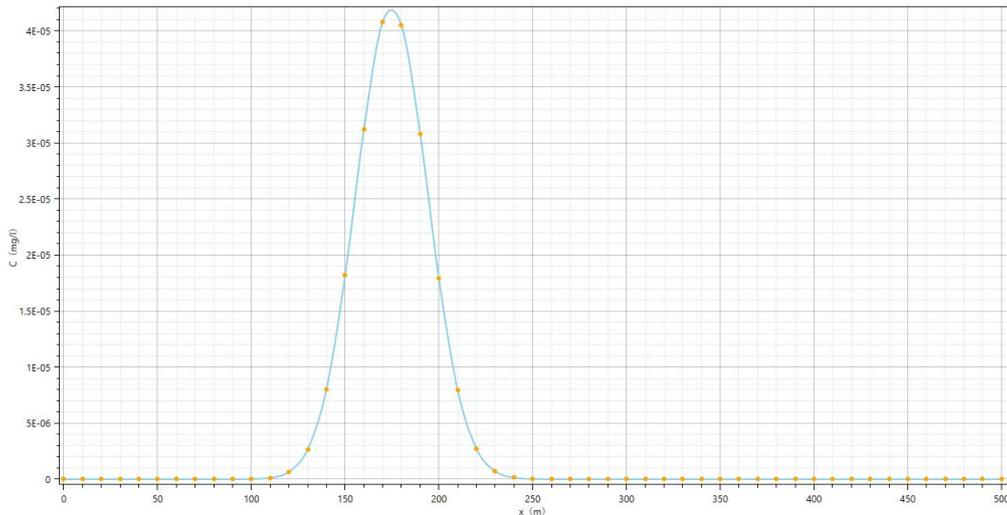
图 5.2-9 污染晕迁移 1000 天氨氮扩散图
