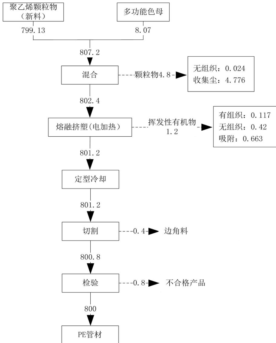
图 3.3-3 PE 管材物料平衡图 (单位: t/a)
