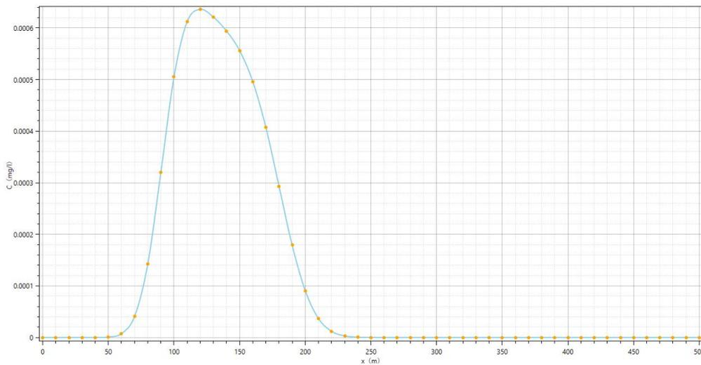
图 5.2-8 污染晕迁移 365 天氨氮扩散图
