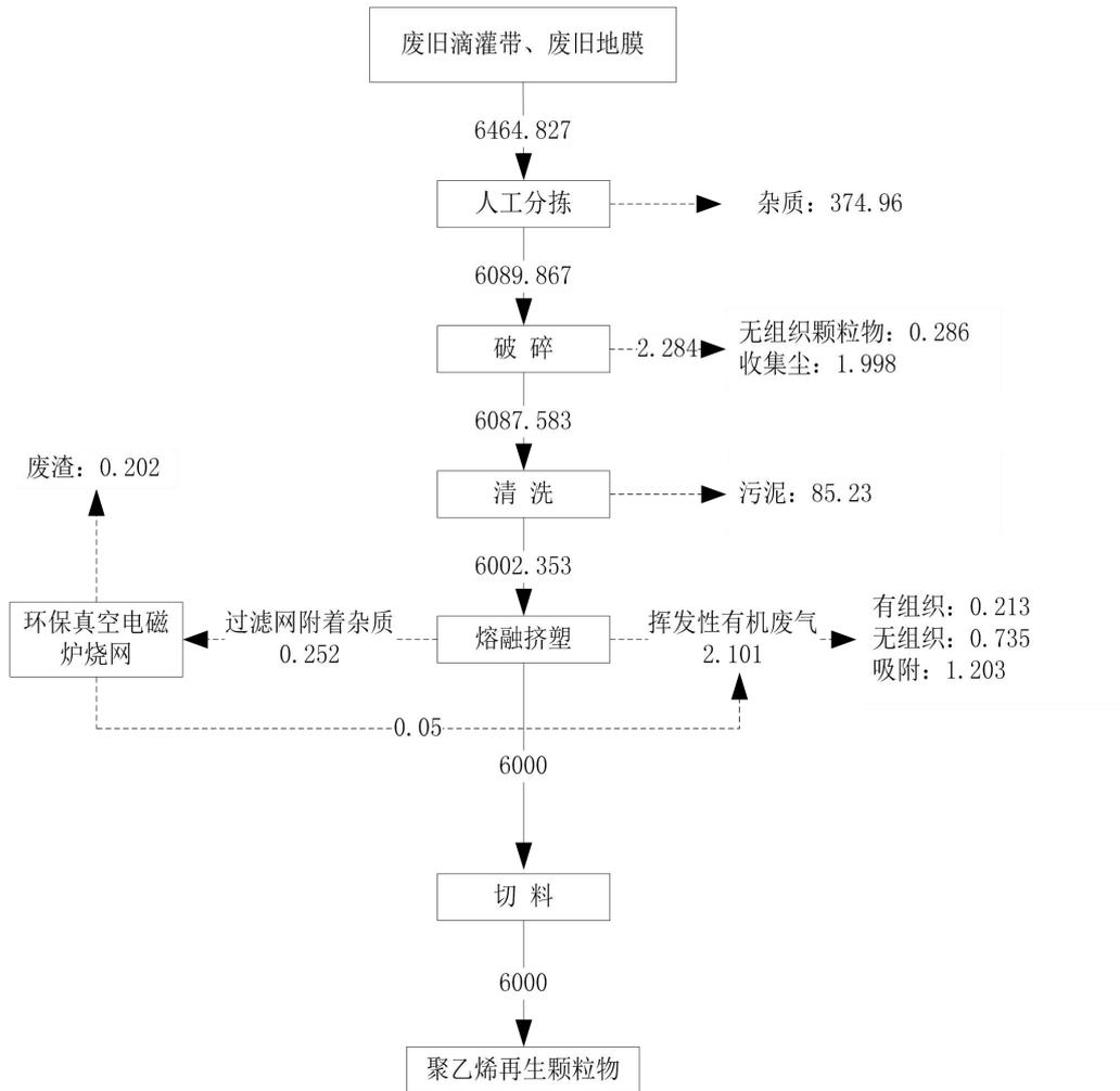
图 3.3-1 再生颗粒物料平衡图 (单位: t/a)
