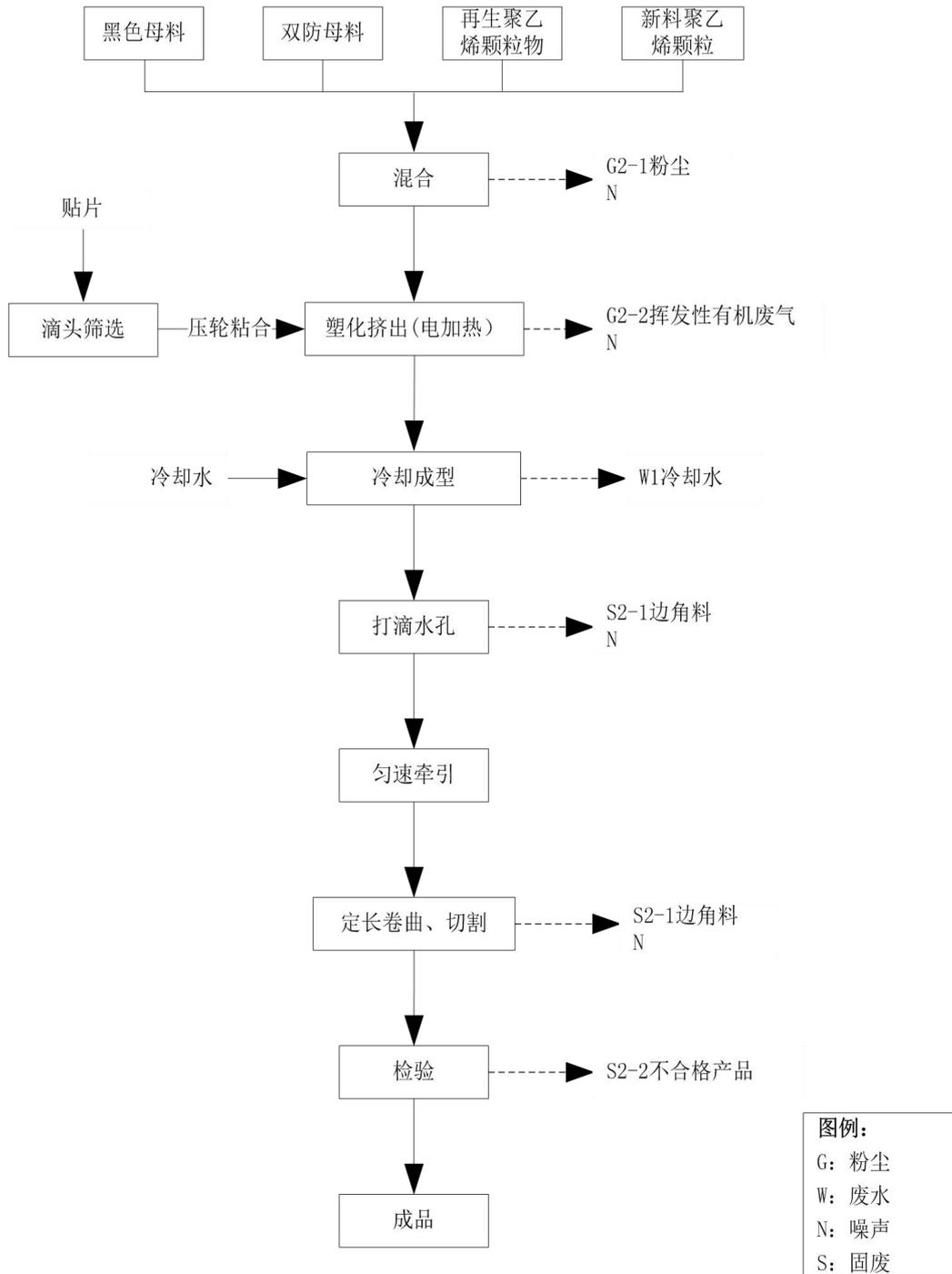
图 3.2-3 内镶贴片式滴灌带生产工艺流程图及产污环节分析图
