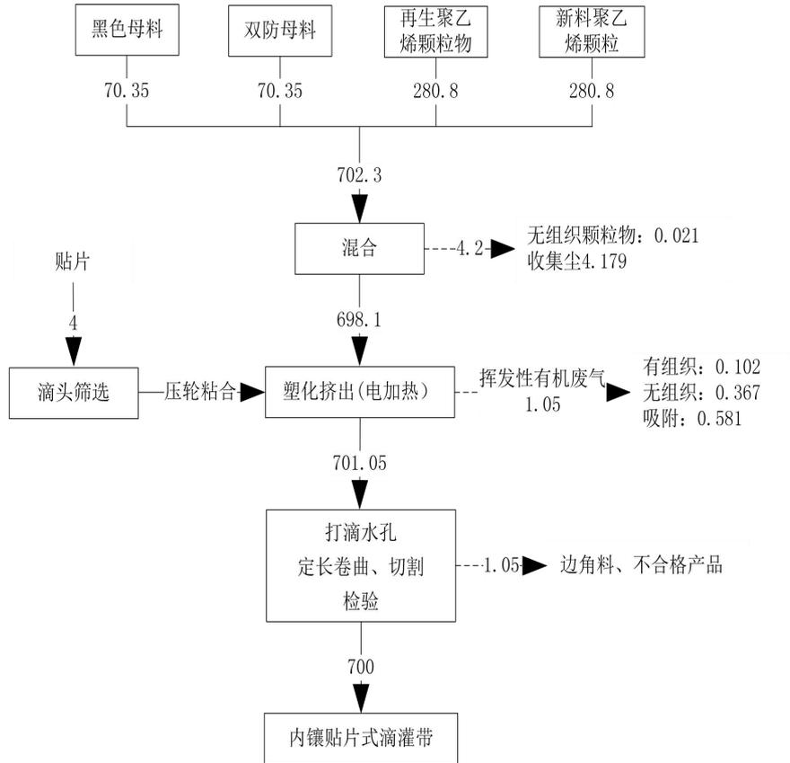
图 3.3-2 内镶贴片式滴灌带物料平衡图（单位：t/a）
