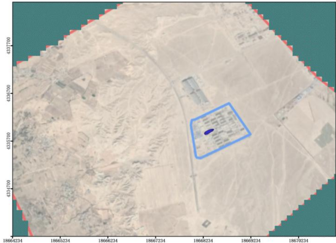
a.发生瞬时泄漏后 100 天三乙胺扩散平面图
