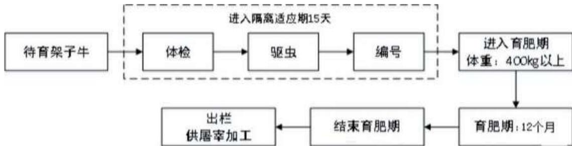
图 3.2-2 肉牛育肥工艺流程图
