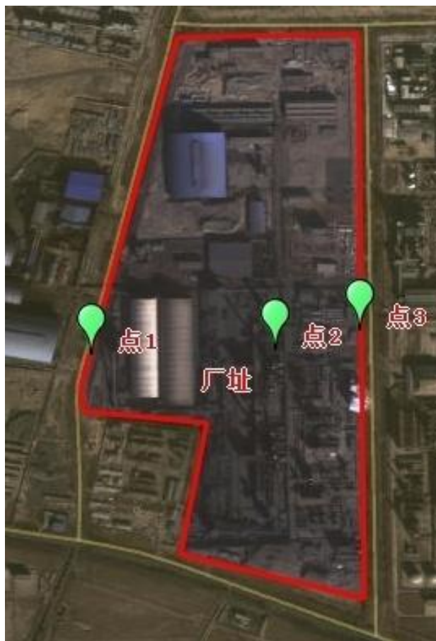
图 9.2-8 地下水监控布点图
